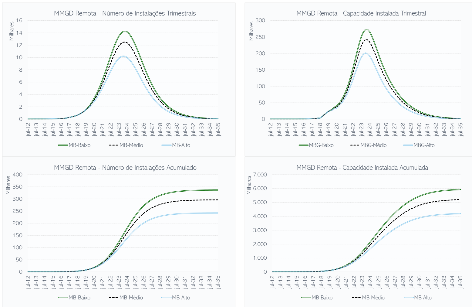
Figura 30: Projeção da inserção da MMGD Remota na CEMIG D com regras de tarifação atuais e cenários de redução de preço da GFV
